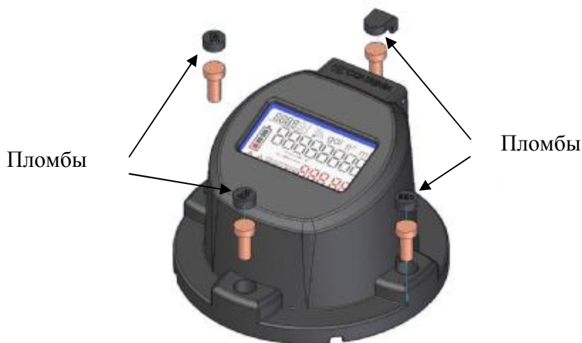
Рисунок 2. Места установки пломб (места пломбирования винтов мастикой с оттиском поверительного клейма)
