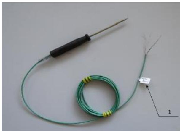
Рисунок 1 – Внешний вид термометра платинового технического ТПТ-7.
