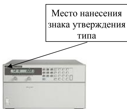
Рисунок 7 – Внешний вид источников серии 669xA
