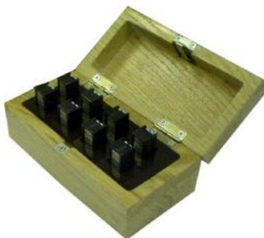
Рисунок 2 – Внешний вид Комплектов светофильтров КСС – 02, КСС – 04
