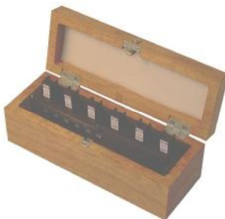
Рисунок 3 – Внешний вид Комплекта светофильтров КСС - 03
