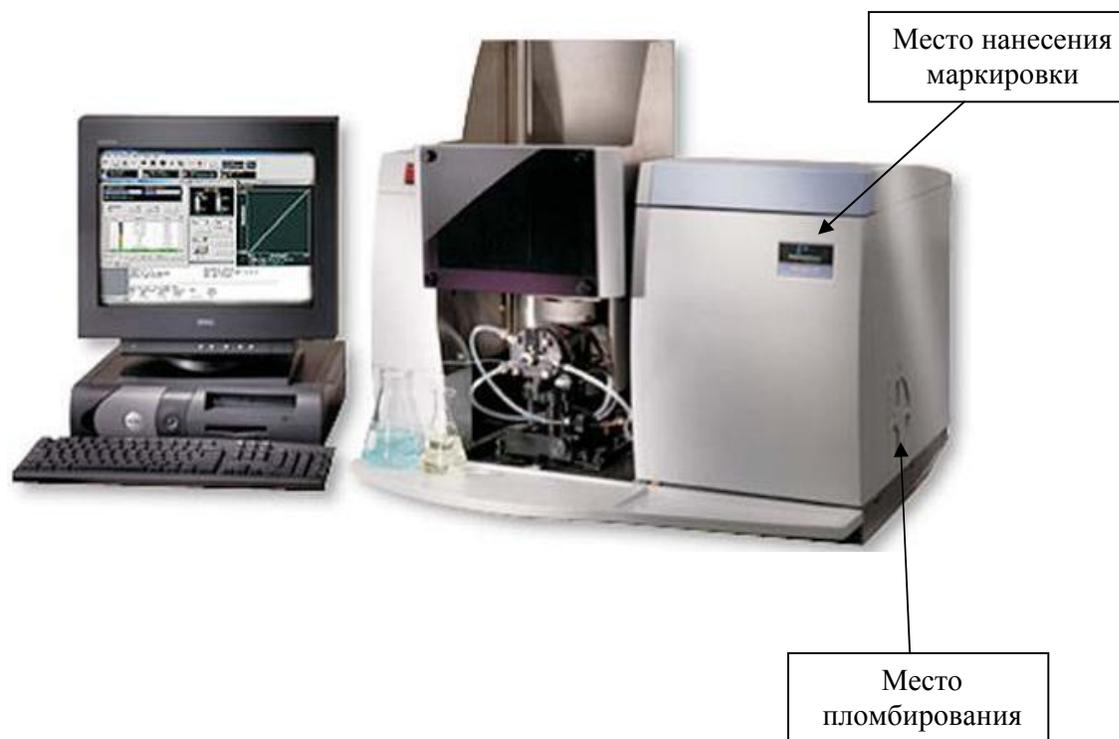
Рисунок 2 – Общий вид спектрометра атомно-абсорбционного AAAnalyst модели 400 и места нанесения маркировки и пломбирования
