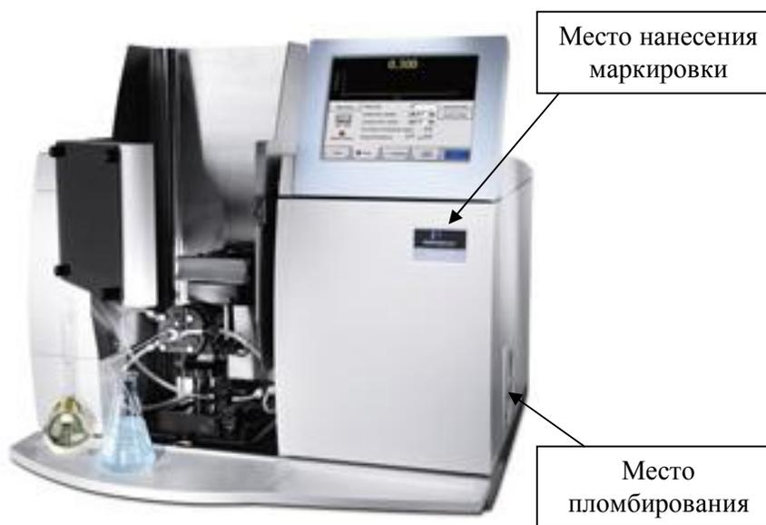
Рисунок 1 – Общий вид спектрометра атомно-абсорбционного AAnalyst модели 200 и места нанесения маркировки и пломбирования
