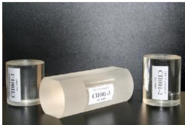
Рисунок 1 – Комплекты образцов толщины и скорости распространения ультразвуковых волн СП001.
