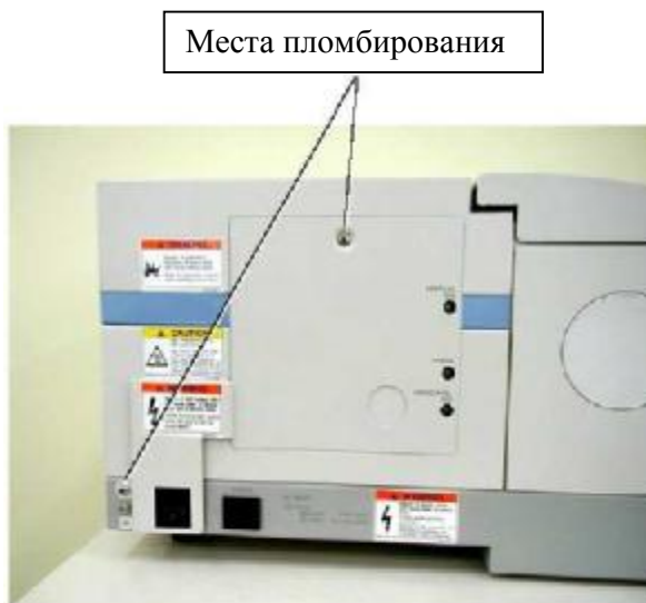
Рисунок 2 – Спектрофлуориметр F-7000 и места пломбирования (вид сзади)
