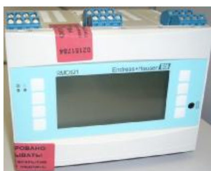
Рисунок 2. Места пломбирования ИВК
