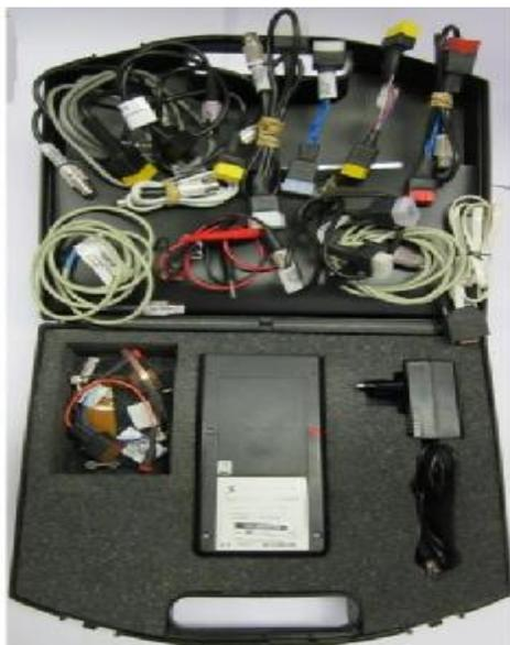
Рис 1. Общий вид программаторов тахографов МКП
