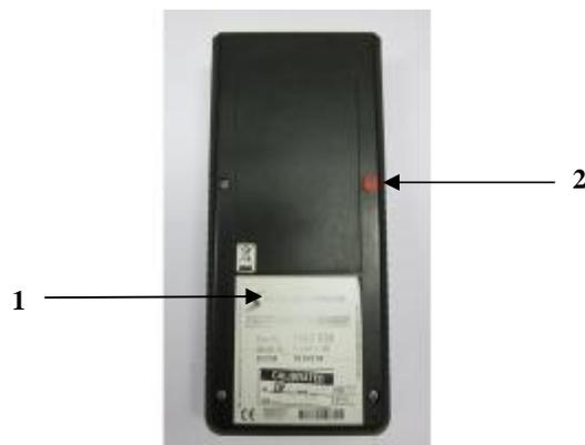
Рис.2 Места нанесения маркировки (1) и пломбирования (2)
