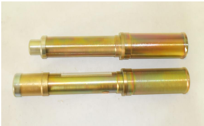
Рисунок 2 — Вид гамма-абсорбционного (сверху) и автоэмиссионного (снизу) измерительных узлов
