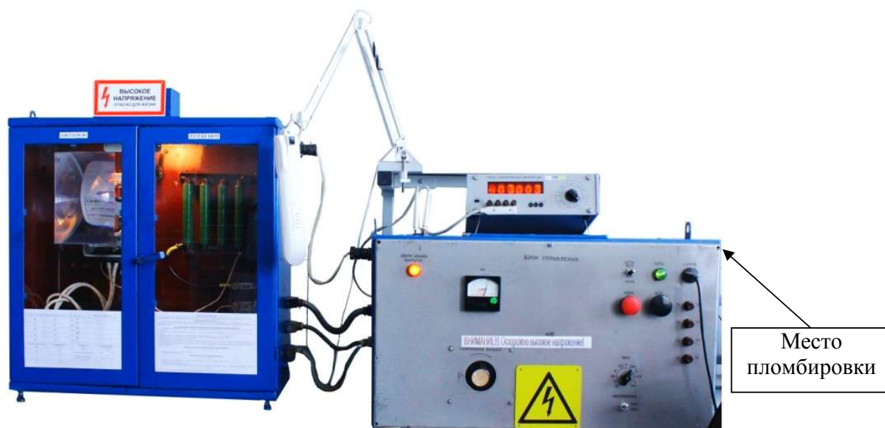
Рисунок 1 - Фотография общего вида установок для поверки счетчиков электроэнергии СКВТ - Д621 тип А2312
