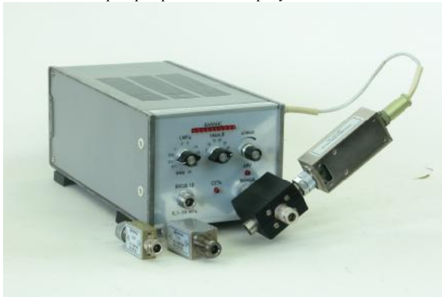
Рисунок 1 Внешний вид калибратора напряжения высокочастотного Н5-4
