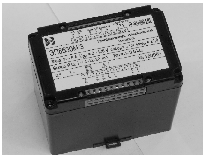
Рисунок 2 - Внешний вид ИП в корпусе с габаритными размерами 125×90×125 мм
