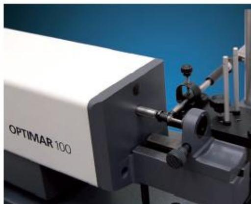
Рисунок 2 – Общий вид прибора для поверки измерительных головок и датчиков Optimar 100 (горизонтальное положение)
