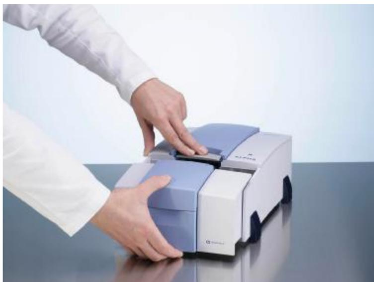
Рисунок 4. Установка сменного модуля "QuickSnap".
