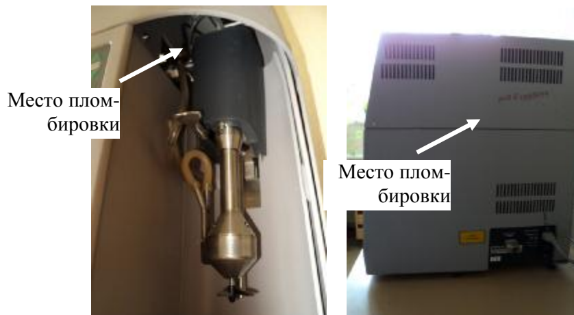
Рисунок 3 – Схема пломбировки анализатора Mastersizer Micro от несанкционированного доступа
