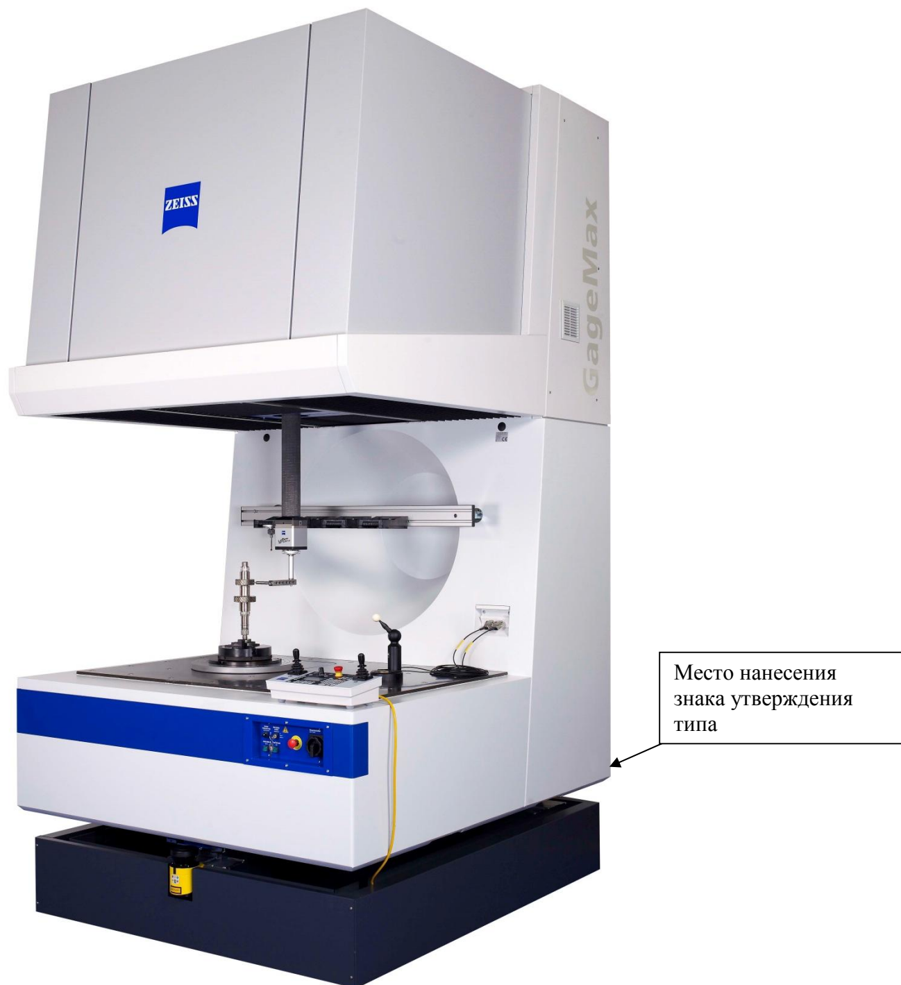
Рисунок 1 - Внешний вид координатных измерительных машин GageMax и место нанесения знака утверждения типа
