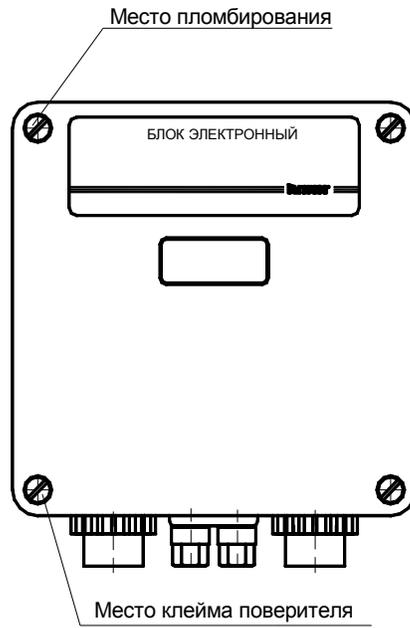
Рисунок 2 – Блок электронный актиметров ПЕЛЕНГ СФ-12
