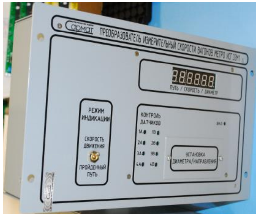
Рисунок 1. Общий вид преобразователя измерительного скорости вагонов метро ИСГ.02М1
