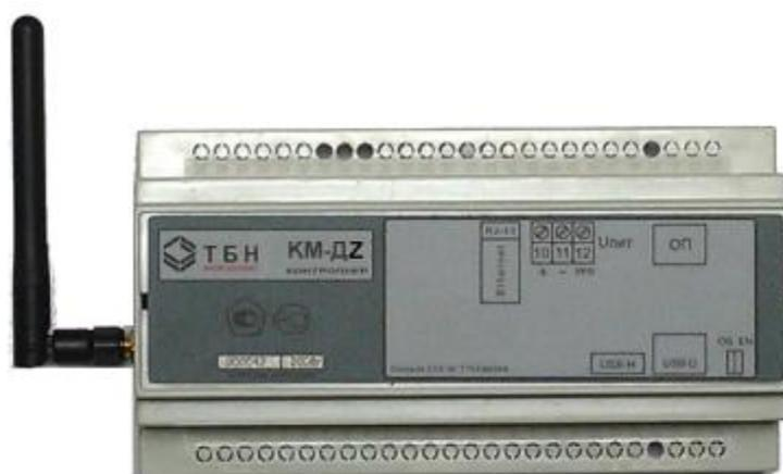
Рисунок - 3. Домовой контроллер КМ-Д
