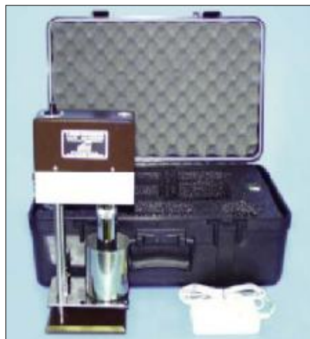
Рис. 1 Внешний вид вискозиметров OFITE, модификации 800 и 900.
