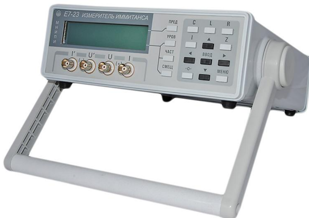
Рисунок 1 - Общий вид измерителей иммитанса E7-23
