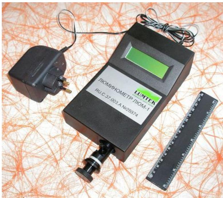
Рисунок 1 - Общий вид люминометра ЛЮМ-1
