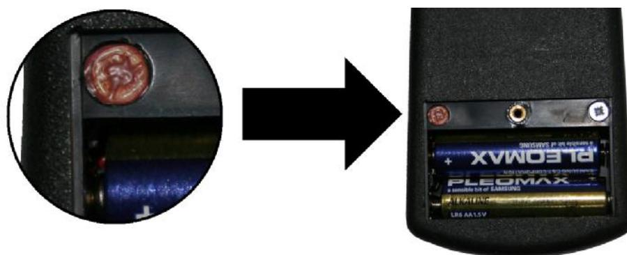
Рисунок 2 – Место пломбирования от несанкционированного доступа.
