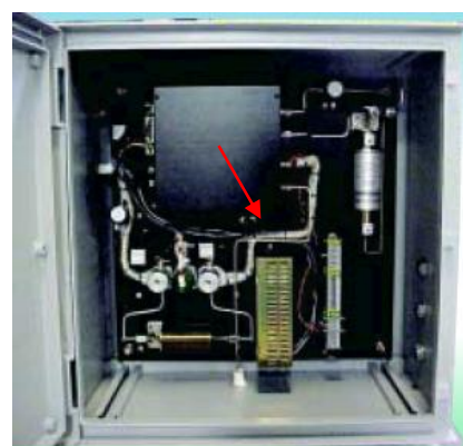
Рисунок 1 - Фотография общего вида анализатора влажности "3050" модель "3050-OLV" во взрывозащищенном корпусе со снятой крышкой (а) и обычное исполнение (б)
