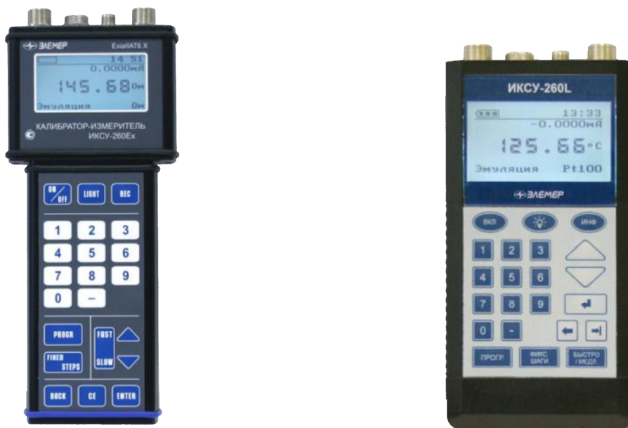
Рисунок 1 – Конструктивные исполнения калибраторов-измерителей унифицированных сигналов эталонных ИКСУ-260
