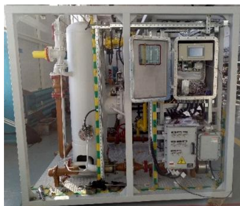
Рисунок 6 - Внешний вид оборудования БТ односкважинной установки с БИОИ взрывозащищенного исполнения
