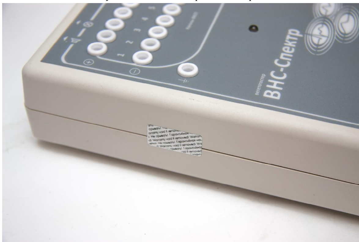
Рисунок 2 - Схема пломбировки от несанкционированного доступа
