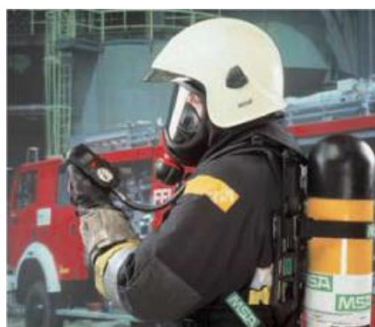
контроллер ICU (на примере аппарата AirMaXX)
