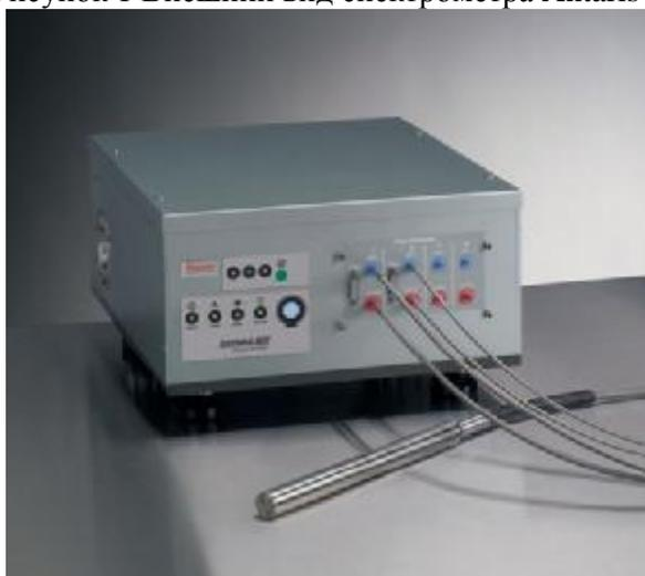
Рисунок 2. Внешний вид спектрометра Antaris MX
