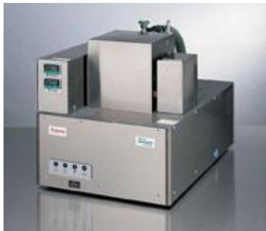
Рисунок 4. Внешний вид спектрометра Antaris IGS
