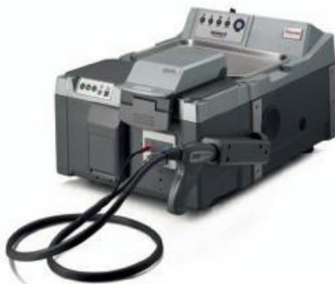
Рисунок 1 Внешний вид спектрометра Antaris II
