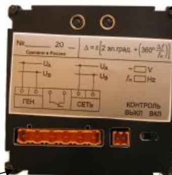
Пломбирование синхроскопа осуществляется мастикой, закрывающей крепёжные винты корпуса, находящиеся на задней стенке корпуса.
