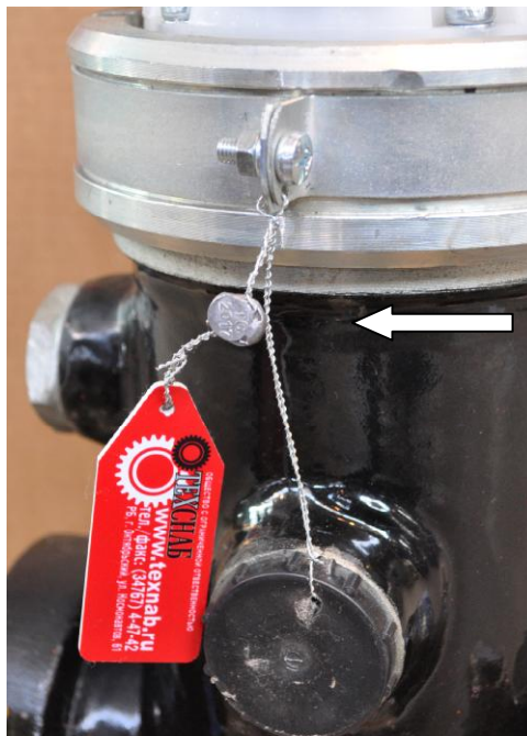
Рисунок 2 - Схема пломбировки от несанкционированного доступа, обозначение места нанесения знака поверки счетчиков жидкости турбинных TOP-T
