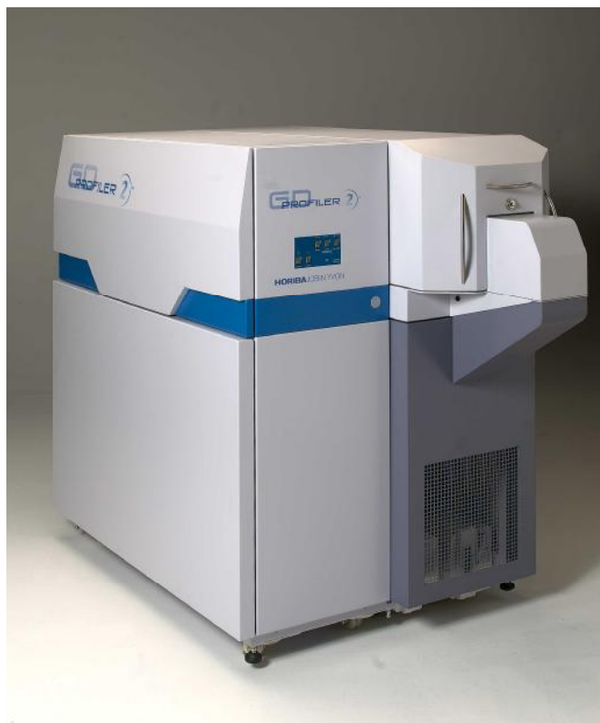
Рисунок 1 – Общий вид спектрометра эмиссионного тлеющего разряда GD-Profiler 2
