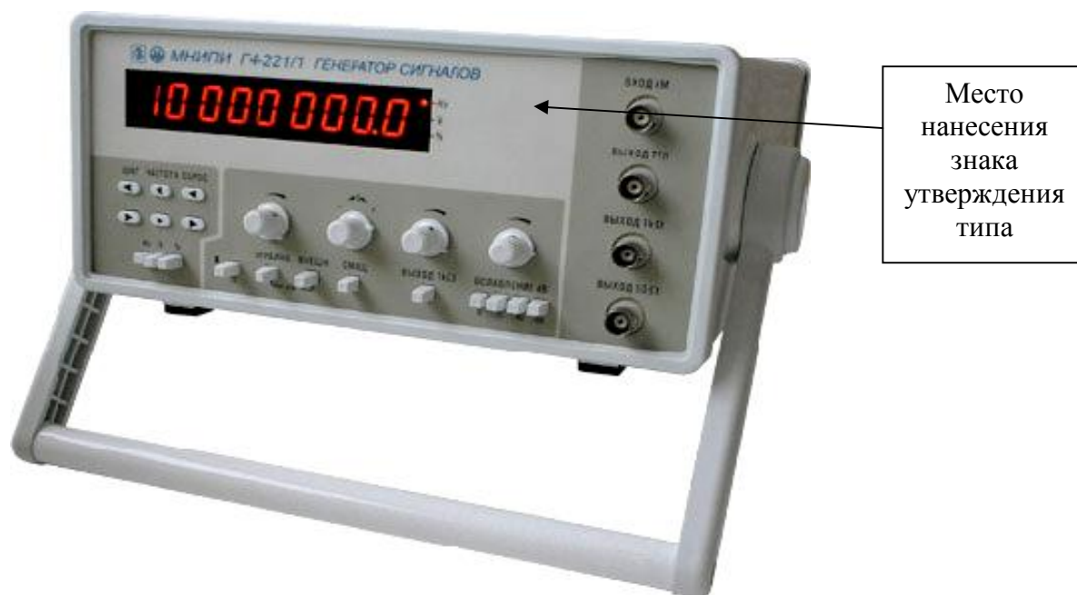
Рисунок 2 - Внешний вид генератора сигнала Г4-221/1
