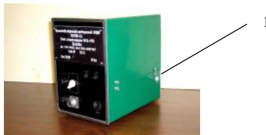
Рисунок 5 - Пломбирование блока искрозащиты БСИ для взрывозащищенных первичных преобразователей ПП ПОТОК-Ех контровочной проволокой и металлическими пломбами (свинцовые или алюминиевые): 1 – место пломбирования.
