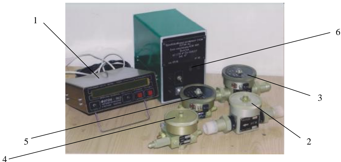
Рисунок 1 - Составные части анализаторов ФОТОН-965.0 и ФОТОН-965.1 (состав и количество в соответствии с модификацией по таблице 1): 1 - блок электроники; 2 – первичный преобразователь обычный (ПП ПОТОК) с исполнением по расходу Р0; 3 – первичный преобразователь
