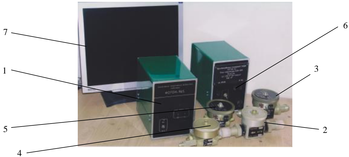
Рисунок 2 - Составные части анализаторов модификаций от ФОТОН-965.2 до ФОТОН-965.7 (состав и количество в соответствии с модификацией по таблице 1): 1 - блок электроники; 2 – первичный преобразователь обычный (ПП ПОТОК) с исполнением по расходу P0; 3 – первичный преобразователь взрывозащищенный (ПП ПОТОК-Ех) с исполнением по расходу P0; 4 - первичный преобразователь обычный (ПП ПОТОК) с исполнением по расходу P01; 5 – первичный преобразователь взрывозащищенный (ПП ПОТОК-Ех) с исполнением по расходу P01; 6 – блок искрозащиты БСИ (в комплекте с ПП ПОТОК-Ех); 7 – монитор персонального компьютера для отображения результатов анализа.
