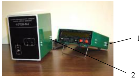
Рисунок 3 - Пломбирование блоков электроники мастичными пломбами: 1 – место установки пломбы на блоки модификаций ФОТОН-965.0 и ФОТОН-965.1; 2 – место установки пломбы на блоки модификаций от ФОТОН-965.2 до- ФОТОН-965.7.
