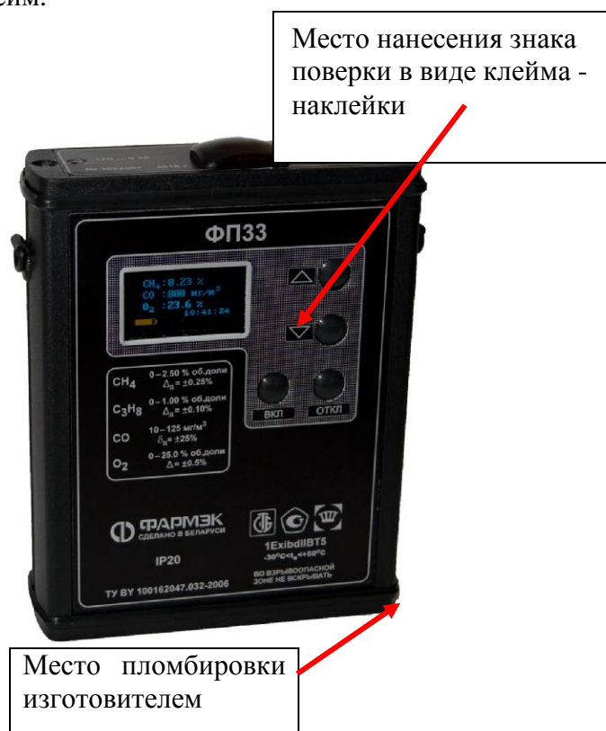
Рисунок 2 - Схема пломбировки для защиты от несанкционированного доступа и обозначение мест для нанесения оттисков клейм.
