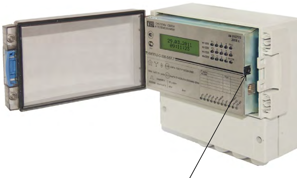
место для нанесения оттиска клейма поверителя
