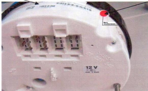
Рисунок 2 - Место пломбирования спидометра электронного 1323
