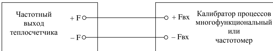
Рисунок Б.2 – Электрическая схема подключения эталонных СИ при поверке активного частотного выхода теплосчетчика.
