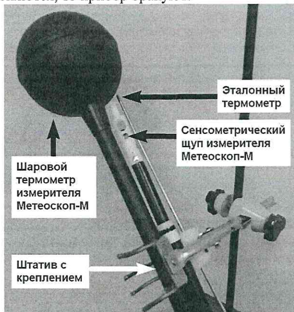
Рисунок 3. Расположение эталонного термометра, шарового термометра и сенсометрического щупа при размещении в климатической камере.
