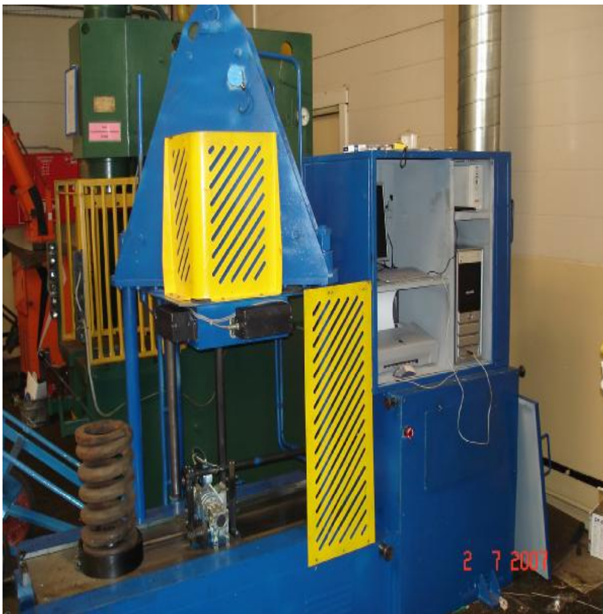
Рисунок 1- Общий вид системы автоматизированной испытания рессорных пружин электропоездов «Лазер-ЭП».
