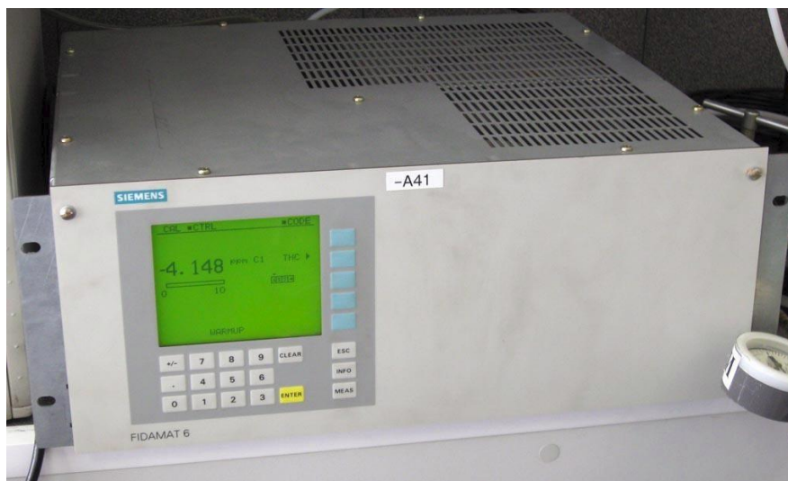
Рисунок 1 - Внешний вид газоанализатора для измерений общего содержания углеводородов Fidamat 6
