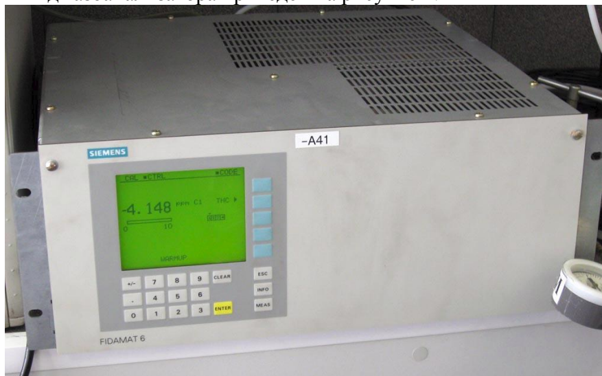
Рисунок 1 – Внешний вид газоанализатора углеводородов Fidamat 6
