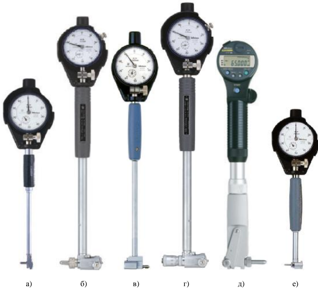
Рисунок 1 – Общий вид модификаций нутромеров серии 511
