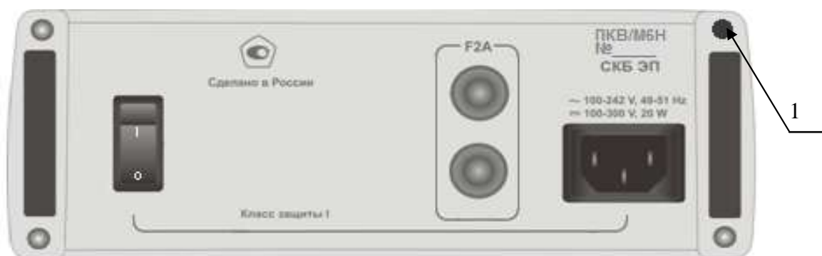
Рисунок 2 - Схема пломбировки от несанкционированного доступа (задняя панель)
