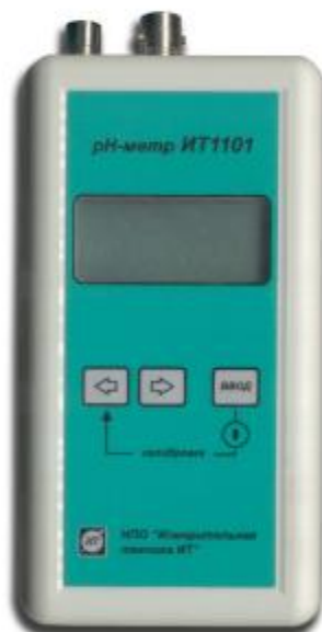
Рис.1. Фотография внешнего вида рН-метр ИТ-1101.
