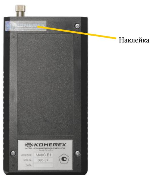
Рисунок 2- Схема пломбировки анализатора
