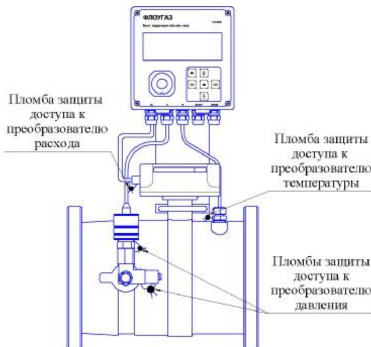
Рисунок 2 – Схема пломбировки комплекса
