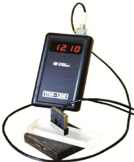
Рисунок 1-Толщиномер магнитный ТПФ-1200
