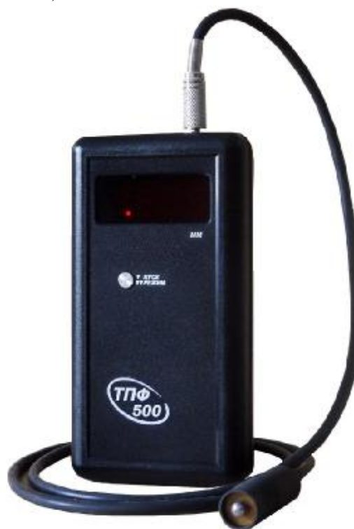
Рисунок 2 – Толщиномер магнитный ТПФ-500
