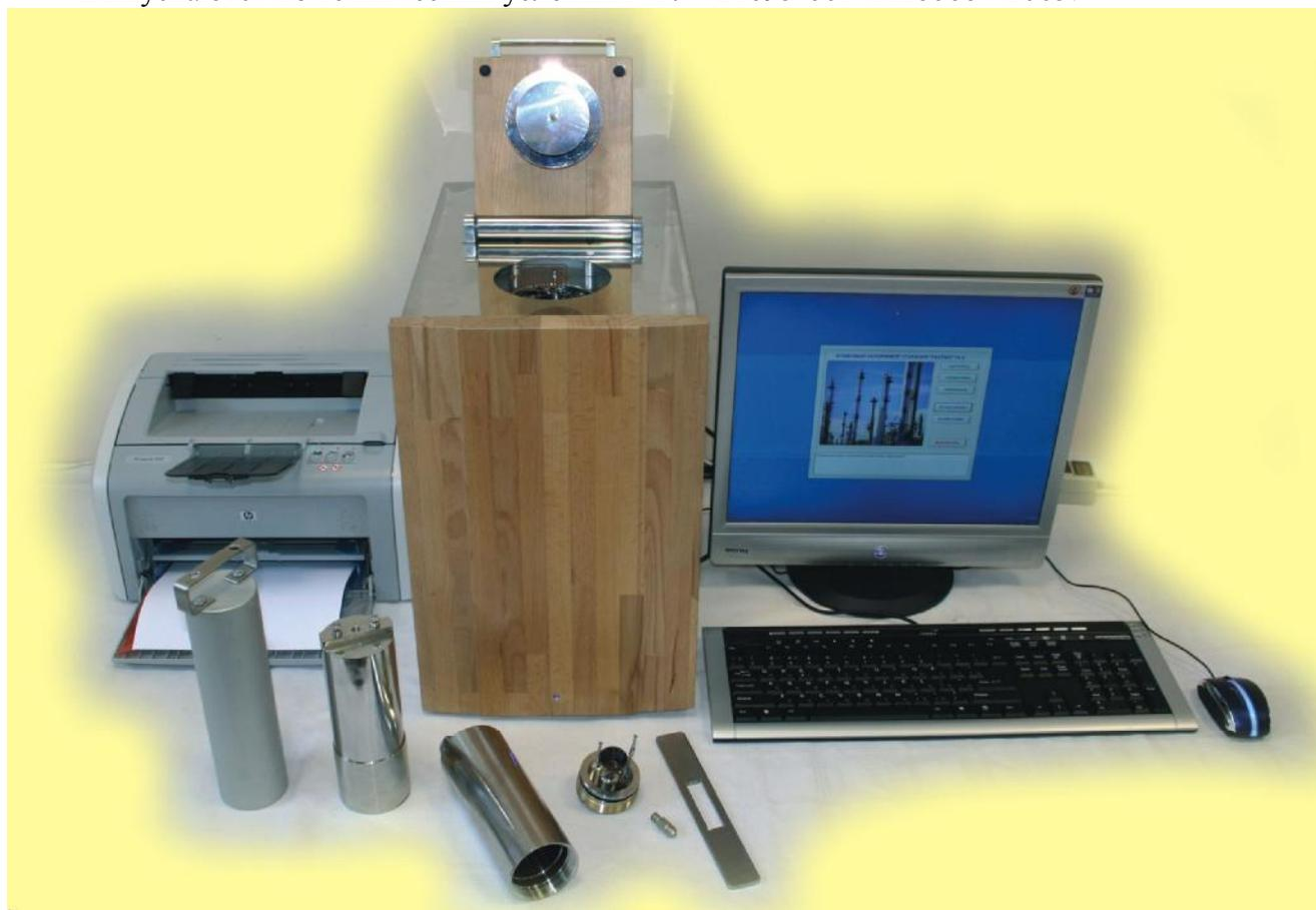
Рис.1. Внешний вид калориметра сжигания бомбового «ТАНТАЛ» модели ТА-5
